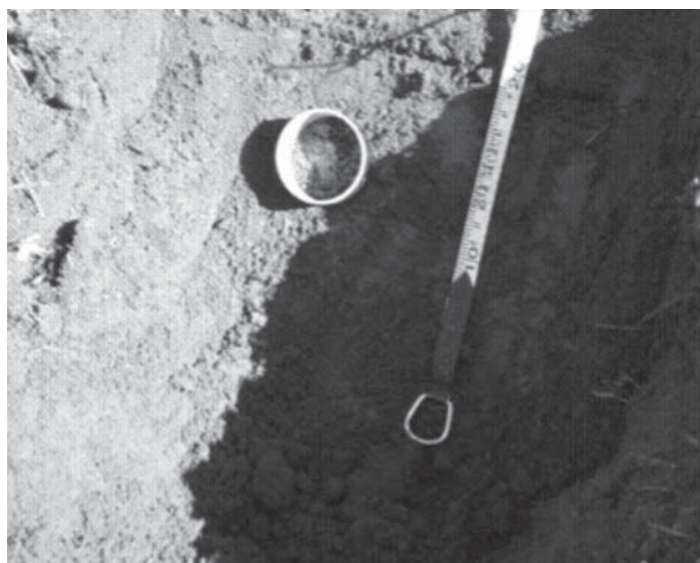
Figura 2 - Coleta do anel volumétrico a 20 cm de profundidade
